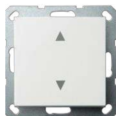
G3018 W Выключатель одноклавишный для штор 10A 250V~ с накладкой белый глянцевый
