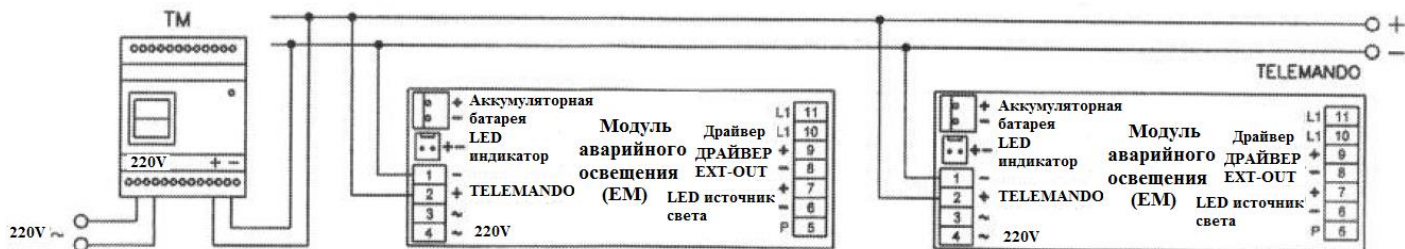
Рис. 3 - Схема подключения с TELEMANDO
