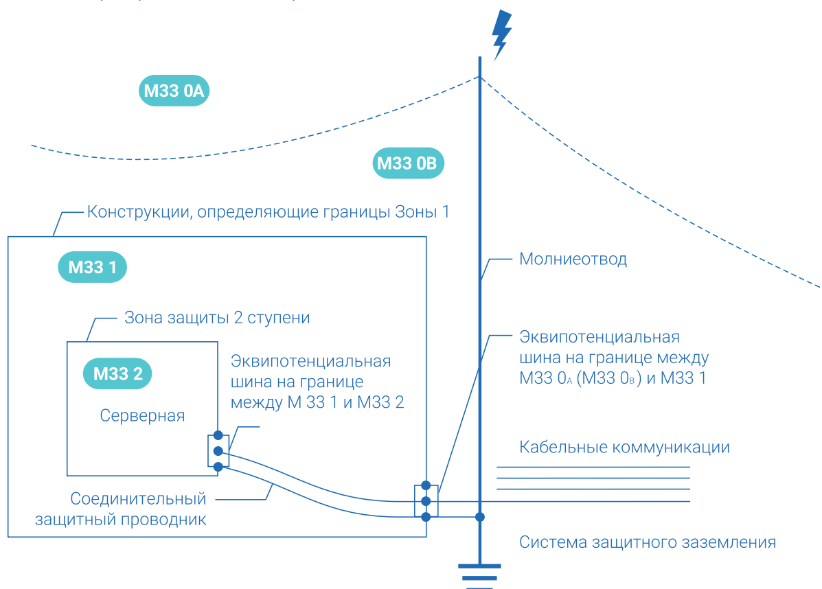
Рис 1. Применение зонной концепции молниезащиты объекта
