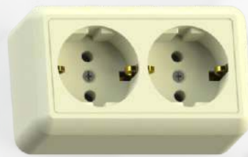
PA16-374 «с/к» Розетка двухместная с заземляющим контактом Номинальный ток - 16А 62х105х42,5 мм
