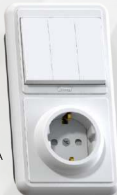
БКВР-209 Блок комбинированный Выключатель трехклавишный с подсветкой + розетка с заземляющим контактом и защитной шторкой Номинальный ток - 10А 82x152x48 мм
