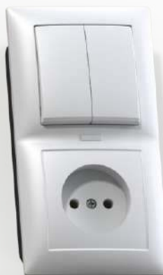
БКВР-418 Блок комбинированный Выключатель двухклавишный с подсветкой + розетка Номинальный ток: - выключателя - 10А - розетки - 16А 80,4x150,4x42,2 мм
