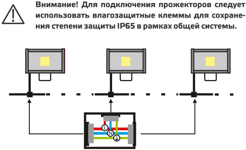
Рис. 1. Схема подключения прожектора к сети электропитания
