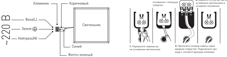
Рис.1. Схема подключения светильника SPO-6-36...-A (с коннектором для БАП). SPO-6-48 и SPO-6-72 к сети 220В.
