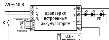
Схема подключения БАП в светильнике NBL-P-LED-A1
