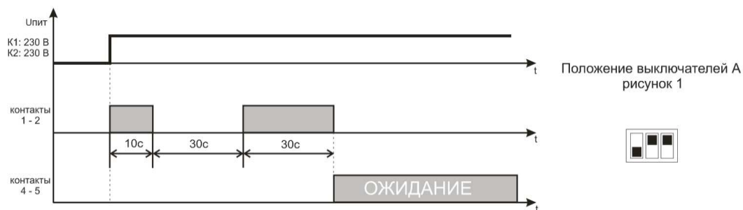
Рисунок 6 – Алгоритм работы Реле управления (предпусковая сигнализация)
