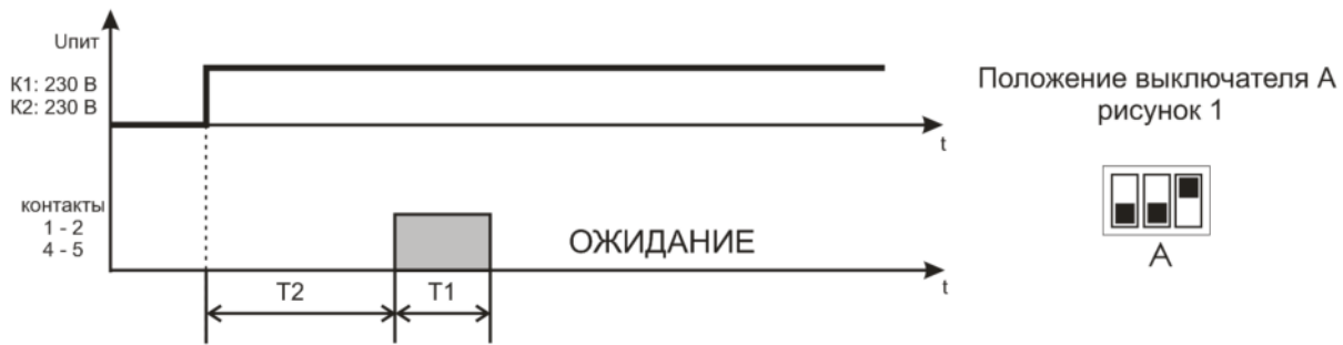
Рисунок 4 – Алгоритм работы Реле импульсное 1
