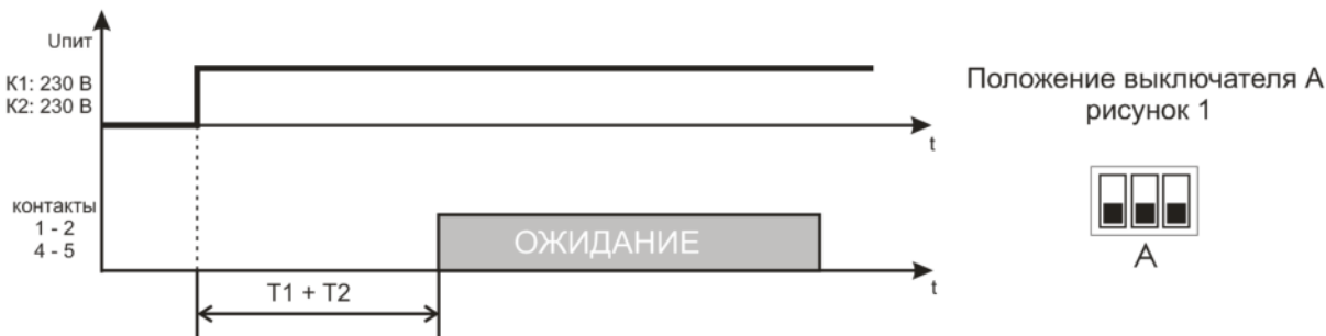
Рисунок 3 – Алгоритм работы Реле с задержкой на включение
