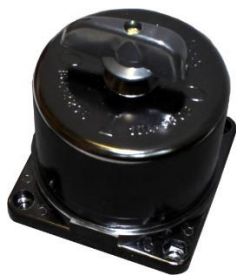
Пакетные выключатели в карболитовом корпусе со степенью защиты IP30, крепление – основанием корпуса
