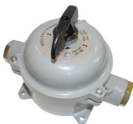
Пакетные выключатели в силуминовом корпусе со степенью защиты IP56, крепление – основанием корпуса
