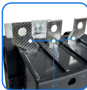
Насечки на присоединительных контактах помогают снизить нагрев проводов, улучшая их фиксацию в точках соединения и суммарно расширяя площадь контакта
