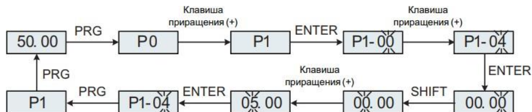
Рисунок 4-3 Параметры Настройка рабочего процесса
