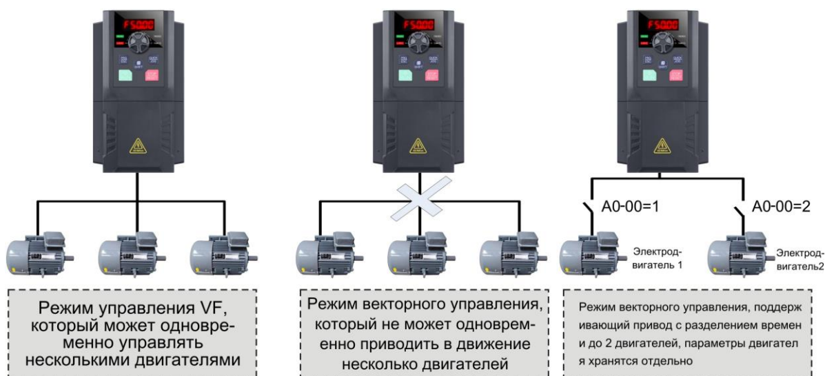
Рисунок 4 - 26 Переключение многоблочных двигателей
