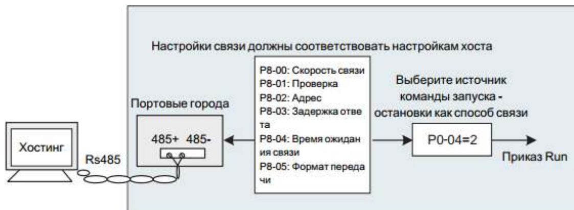
Рисунок 4 - 10 Схема запуска и остановки управления связью
