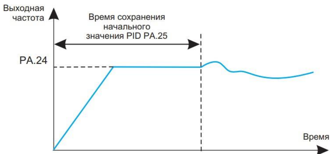
Рисунок 6 - 25 Функциональная схема начального значения PID
