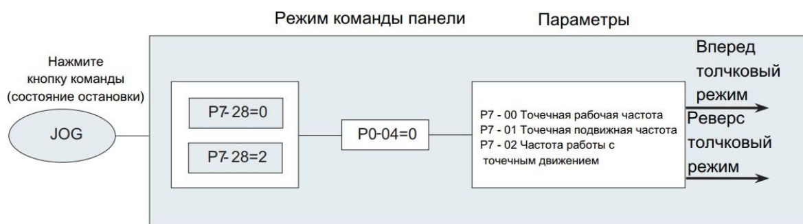
Рисунок 4 - 15 Схема настройки параметров толчкового режима
