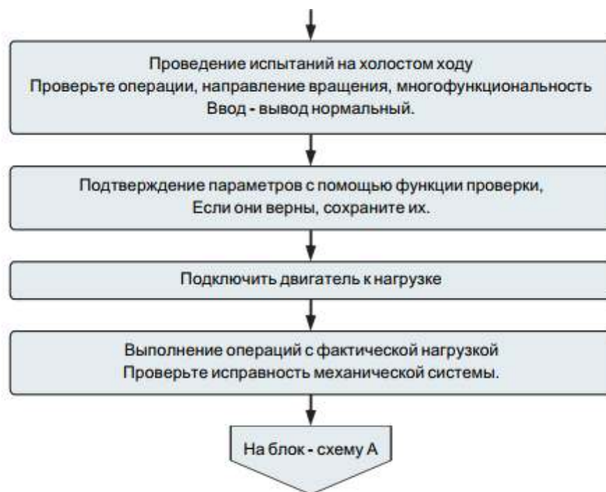
Рисунок 4 - 6 Шаги действия режима управления вектором открытого кольца
