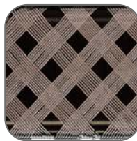
Сечение экрана составляет не менее 1 мм 2 , плотность – не менее 60 %
