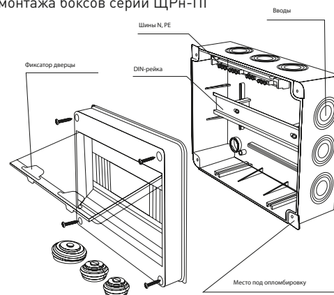
Схема монтажа боксов серии ЩРН-ПГ
