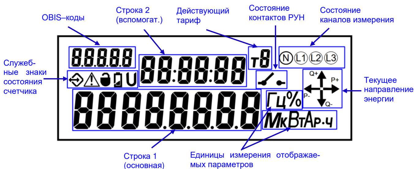
Рисунок 9 – Отображаемая информация на ЖКИ счетчика в корпусе «S7»
