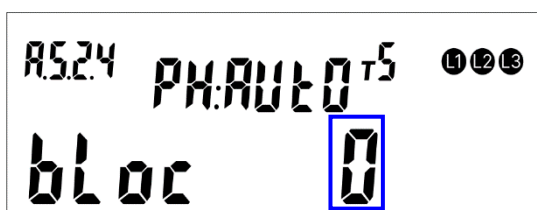
Рисунок 182 – АВТО, реле управляется алгоритмами счетчика
