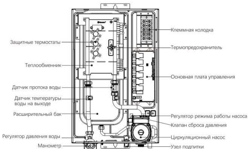
Рис. 2. Схема внутреннего устройства изделия
