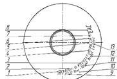
Чертеж 1 D – диаметр баллона, H – высота баллона, S – толщина стенки.
