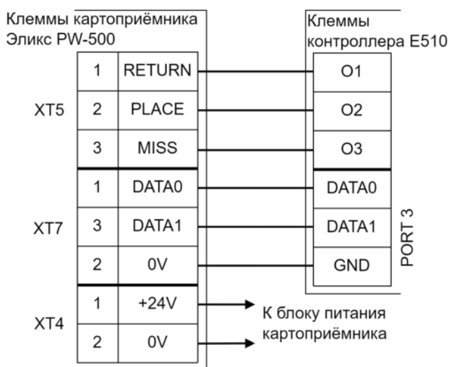
Пример подключения Эликс PW-500 нового образца в направлении «Выход».
