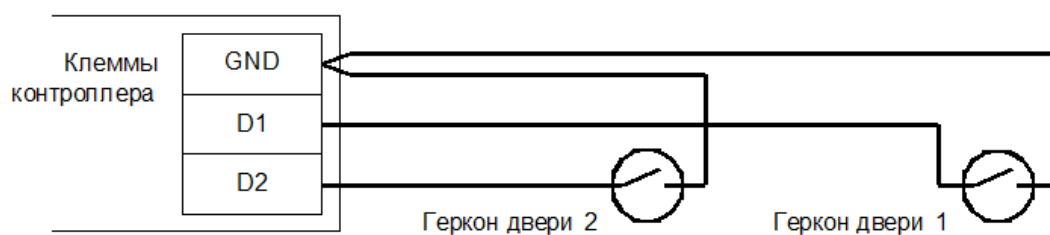
Подключение датчиков открытия дверей.
