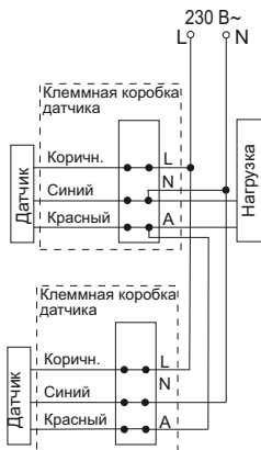
Рисунок 6 – Схема параллельного подключения датчиков движения
