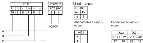
a) схема подключения 3-ф. амперметра при I \leq 5 A
