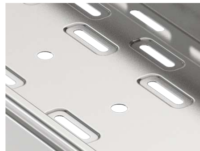
Объемная перфорация увеличивает несущую способность кабельного лотка и улучшает вентиляцию кабелей и проводов.
