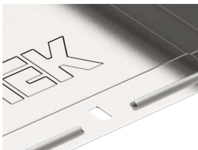
Подштамповка торцевых краев исключает повреждение изоляции кабеля при монтаже.
