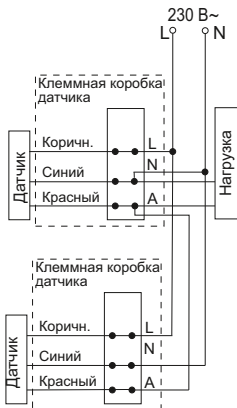
Рисунок 3 – Схема параллельного подключения датчиков движения
