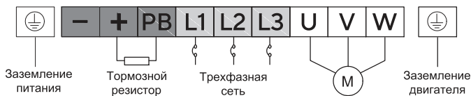
в) трехфазный преобразователь, мощностью 11–22 кВт
