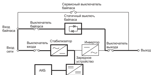
Рисунок 9 – Схема работы ИБП в режиме байпаса
