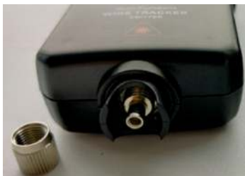
Рисунок 4 – Оптический разъём генератора сигнала
