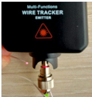
Рисунок 13 – Проверка оптического волокна на обрыв
