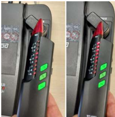
Рисунок 12 – Бесконтактное определение наличия напряжения
