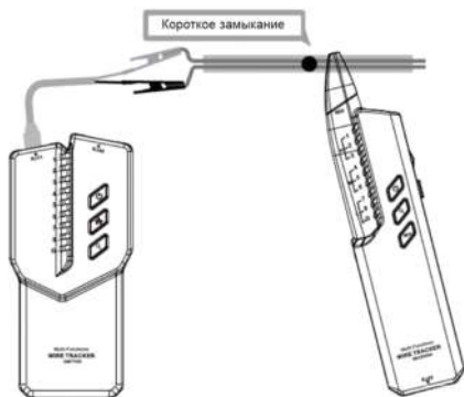
Рисунок 9 – Поиск короткого замыкания сетевого кабеля
