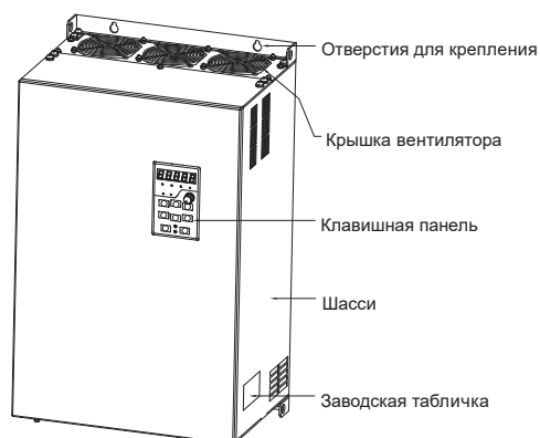
Рисунок 2.4 – Пример компоновки 37 ÷ 450 кВт
