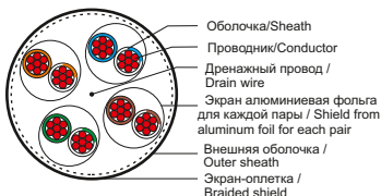
Рисунок 6 - Конструкция патч-корда категории 6A типа S/FTP / Figure 6 - Design of S/FTP patch cord of 6A category
