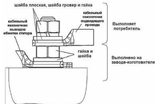
Рисунок 4— Схема контактного соединения
