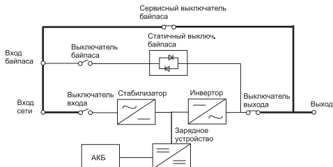
Рисунок 11 – Схема работы ИБП в режиме технического ремонта
