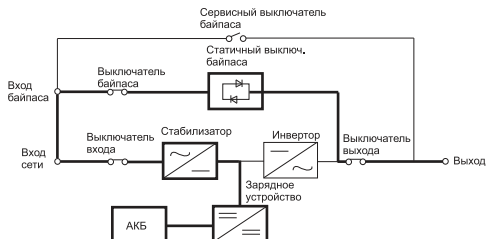
Рисунок 10 – Схема работы ИБП в режиме байпаса
