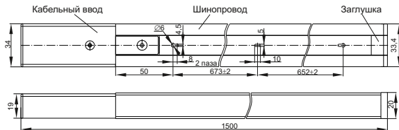
Рисунок 2 – Габаритные размеры шинопровода
