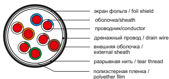
Рисунок 2 – конструкция кабеля типа F/UTP / Figure 2 – F/UTP type cable design
