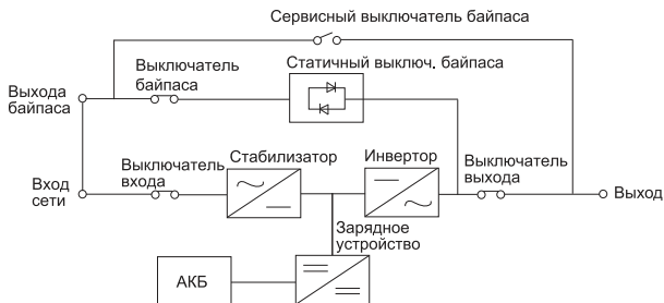
Рисунок 7 – Схема работы ИБП в стандартном режиме
