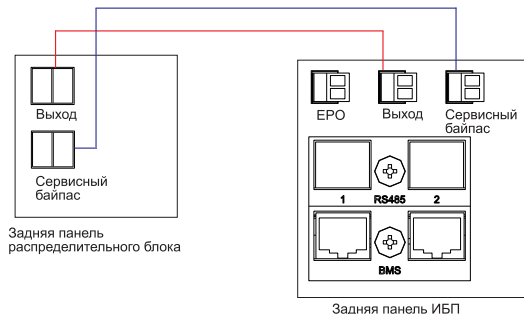
Рисунок 26 – Схема подключения контактов к распределительному блоку
