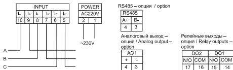
а) схема подключения 3-ф. амперметра при I \leq 5 A / connection diagram of 3-ph. ammeter at I \leq 5 A
