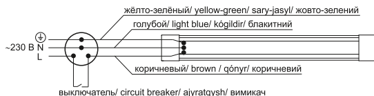
Рисунок / Figure / Sýret/ Рисунок А.3 – Подключение светильника/ Luminaire connection/ Shyragdandy qosý/ Підключення світильника
