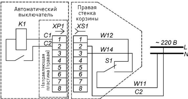
Схема 1 Подключение электрической блокировки без управления НР
