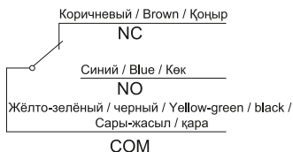
Рисунок 2 – Электрическая схема сигнализатора / Figure 2 – Electrical diagram of the switch / 2 сурет – Дабылдағыштың электрлі схемасы
