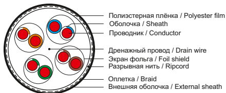
Рисунок 1 – Конструкция кабеля типа S/FTP / Figure 1 – Cable design of S/FTP type
