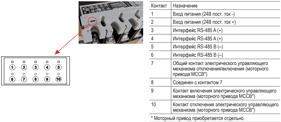
Рисунок 11 – Назначение контактов разъема Modbus
